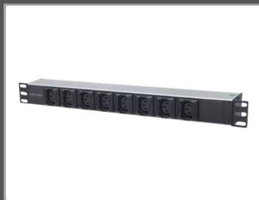
und rückseitigem C20-Stromeingang - 1 HE - Stromverteilungseinheit (Rack - einbaufähig) - WS 110-250 V - Eingabe - Eingang IEC 60320 C14 - Ausgangsanschlüsse: 8 (IEC 60320 C13) - 1U - 48.3 cm (19") - 2 m
